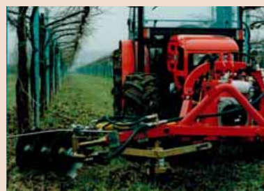
Mantovani ha sperimentato anche le dischiere motorizzate per rinalzata e scalzata dei filari
