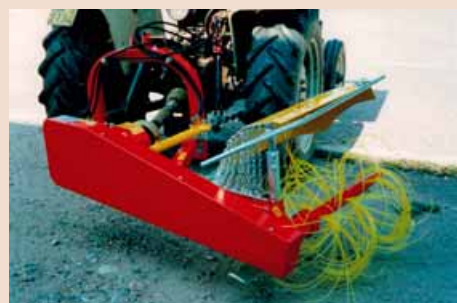
La prima diserbatrice prodotta da Mantovani era derivata da una motofalciatrice portata a barra, sulla quale le cinghie di trasmissione anziché muovere le lame facevano girare il cilindro con i flagelli
