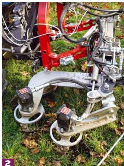
**1.** La **Roto-Zappa** ha la particolarità di presentare **due organi lavoranti (rotori), che operano simultaneamente** ruotando in senso opposto: il secondo erpice, controrotando rispetto al primo, provvede a livellare il terreno lavorando accuratamente e non ci sarà così bisogno di ricorrere a un secondo passaggio
